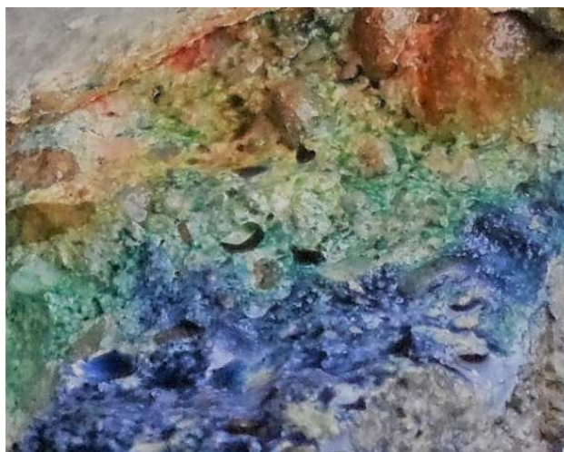
Rys. 23. Przykład profilu rozkładu pH w próbce betonu [106]
