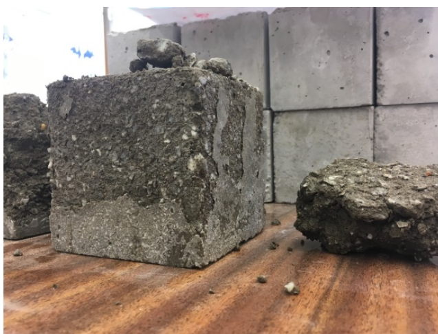
Rys. 8. Próbką po badaniu mrozoodporności – powierzchnia próbki uległa wyraźnemu uszkodzeniu świadczącemu o niespełnieniu wymagań
