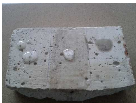
Rys. 17. Skuteczność hydrofobizacji: powierzchnia betonu zaimpregnowana preparatami o różnej skuteczności (po lewej i w środku) i nieimpregnowana (po prawej)
