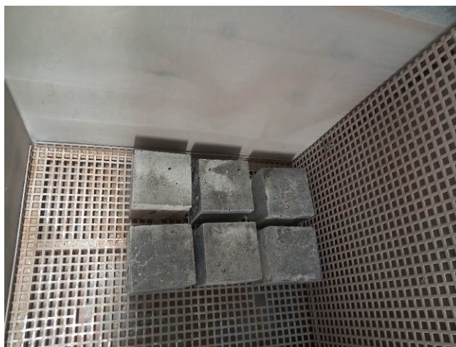
Rys. 7. Komora z próbkami w trakcie badania mrozoodporności betonu metodą zwykłą PN-B-06265 – widoczne spękania powierzchni
