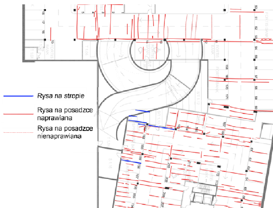
Rys. 21. Przykład fragmentu katastru rys stropu kondygnacji podziemnej budynku biurowego
