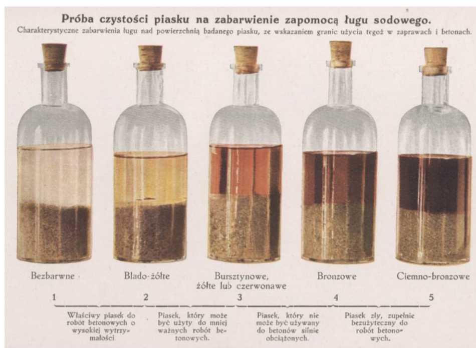
Rys. 28. Sposób sprawdzenia czystości piasku do betonu [54]
