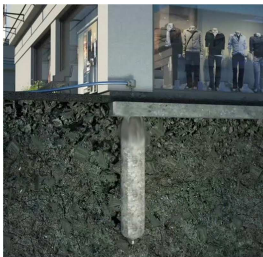
Rys. 52. Schemat wzmocnienia podłoża za pomocą iniekcji geopolimerowej (materiały [M4])
